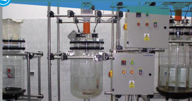
Laboratoryjna aparatura do realizacji ciągłych procesów ekstrakcji cieczowej (pojemność mieszalnika 0,5 dm 3 i odstoju 1,5 dm 3 )
