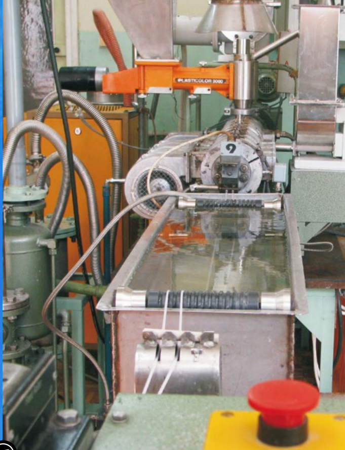
Pilotowa linia do wytwarzania kompozytów polimerowych z odpadu poliwęglanu
