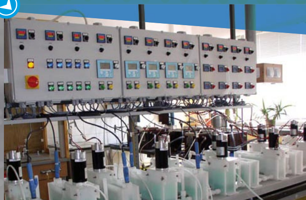
Laboratoryjna aparatura do realizacji ciągłych procesów ekstrakcji cieczowej (pojemność mieszalnika 0,5 dm 3 i odstoju 1,5 dm 3 )
