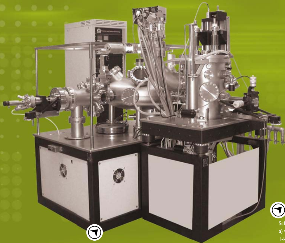
Uniwersalny zestaw aparaturowy do kompleksowych badań właściwości ciekłych metali i stopów w wysokiej temperaturze
