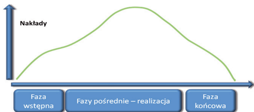
Rysunek 1. Typowy przebieg nakładów w projekcie - zaznaczona została faza wstępna z procesami inicjowania i planowania, faza realizacji oraz faza końcowa (na podstawie PMBoK 3 ).
